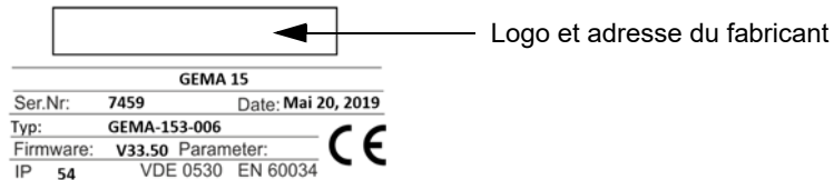
Figure 8: Exemple de plaque signalétique de la boîte de contrôle GEMA
