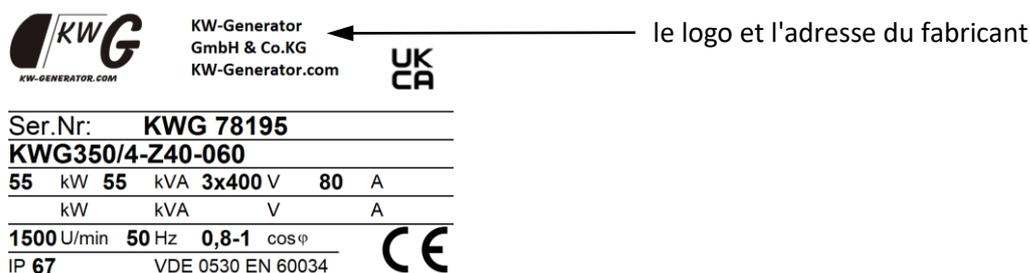
Illustration 1: Exemple de plaque signalétique d'un générateur
