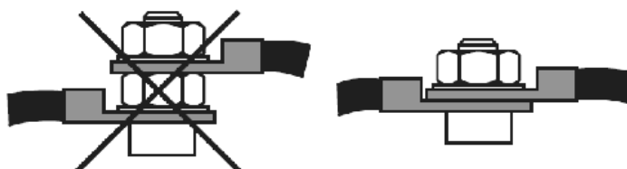
Ilustración 2 Montaje correcto de las zapatas de la horquilla anular
